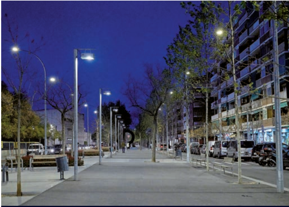
En los tramos ya renovados de la av. de la Verge de Montserrat conviven dos tipos de farolas: las pensadas para las calzadas (circulación de vehículos), más altas, y las diseñadas para iluminar las zonas peatonales, más bajas. Este criterio se extenderá a toda la ciudad, donde se crea necesario.
