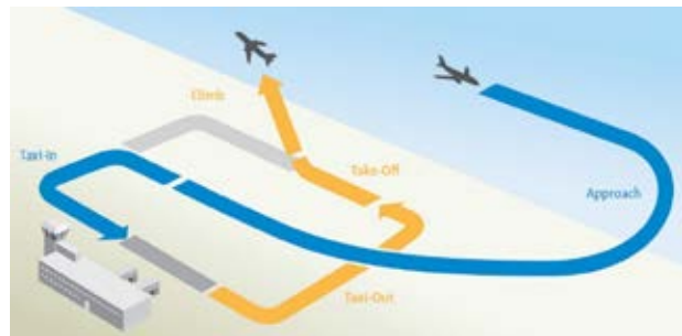
Imatge 10 Esquema del cicle LTO.
