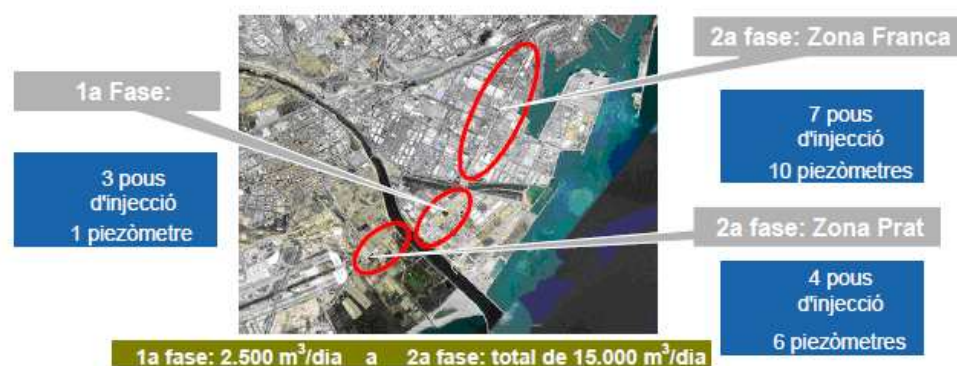
Figura 3.3.5. Fases del projecte de barrera hidràulica i localització dels pous d'injecció
